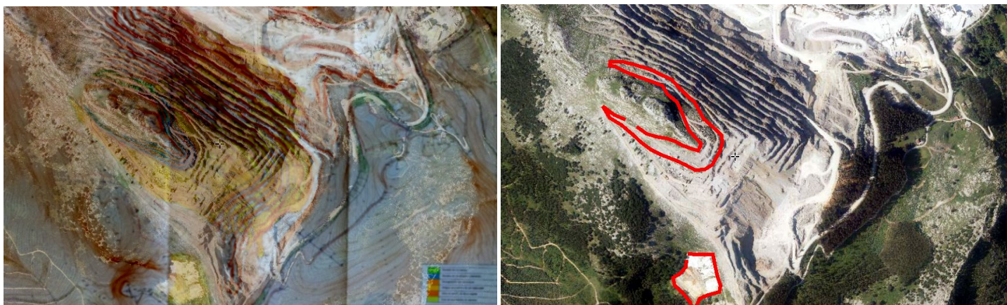
Superposición aproximada de las zonas a restaurar en los bancos superiores y escombrera de cal (foto izquierda); delimitadas con una línea roja (foto derecha) dentro de cuyo contorno se aprecia con claridad que no se ha producido la restauración indicada en el Plan de Restauración de 2008. La ortofoto de la derecha corresponde a la web de Mapas de Cantabria de 2020.
