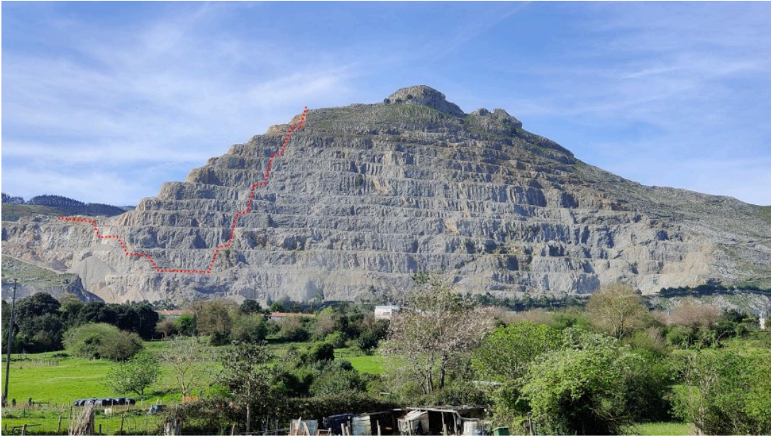
Simulación de recorte entre la ladera norte y ladera este en el estado final de la fase 3.
