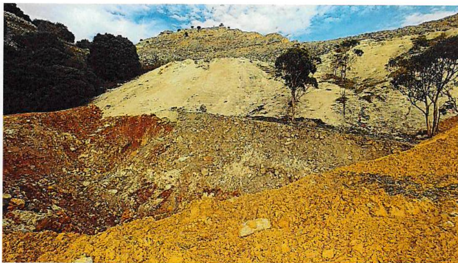
Mezcla de residuos de cal con residuos de cantera y estériles. 4 de noviembre de 2018.
