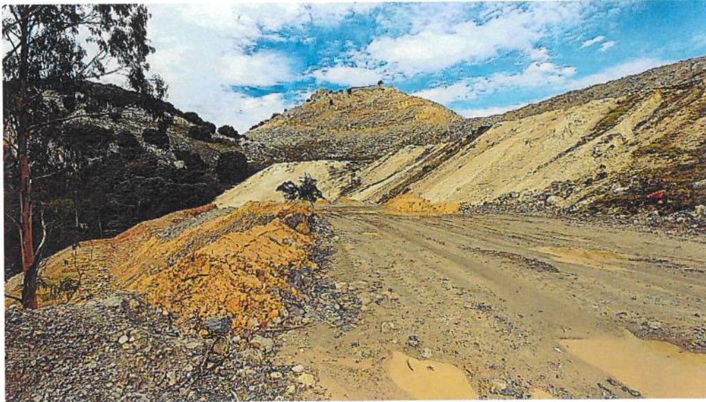
El calero, en la zona suroeste de la explotación. 4 de noviembre de 2018. En la zona inferior de la escombrera, la cal se ha sepultado con residuos o estériles de la cantera.
