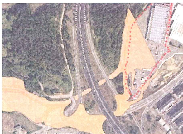
Superposición de los límites de la unidad de ejecución 1.75 sobre la zona inundable del río de Sámano que afecta a una buena parte del aparcamiento, y del recinto que alberga las instalaciones de la gasolinera.
